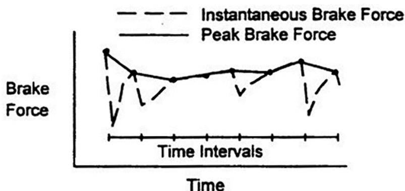
**FIGURE 4. INSTANTANEOUS BRAKE FORCE AND PEAK BRAKE FORCE**
