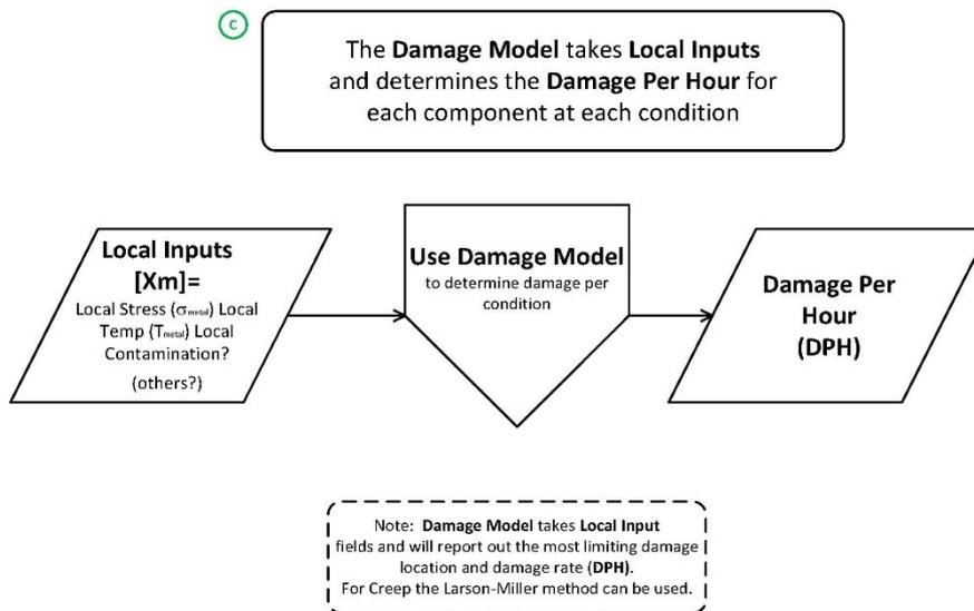
**Figure 8.8. Damage Model**
