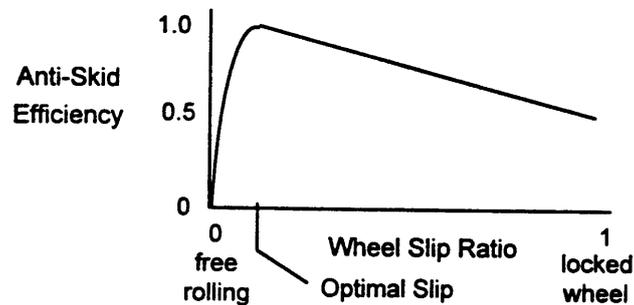
FIGURE 5. ANTI-SKID EFFICIENCY – WHEEL SLIP RELATIONSHIP
