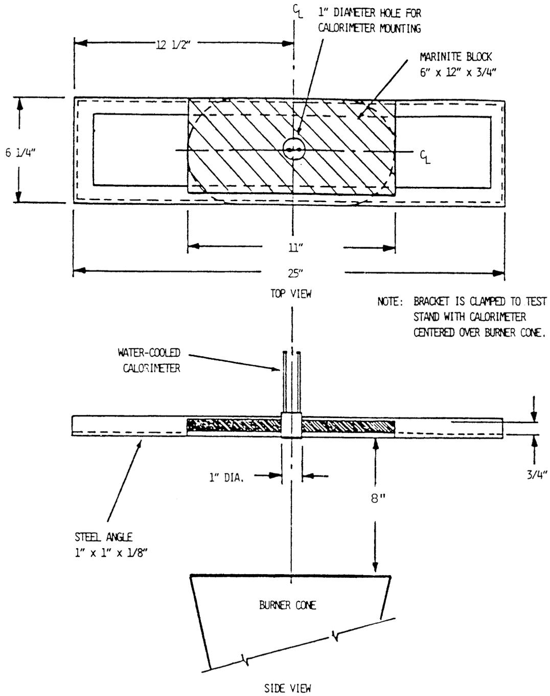
FIGURE 2 CALORIMETER BRACKET
