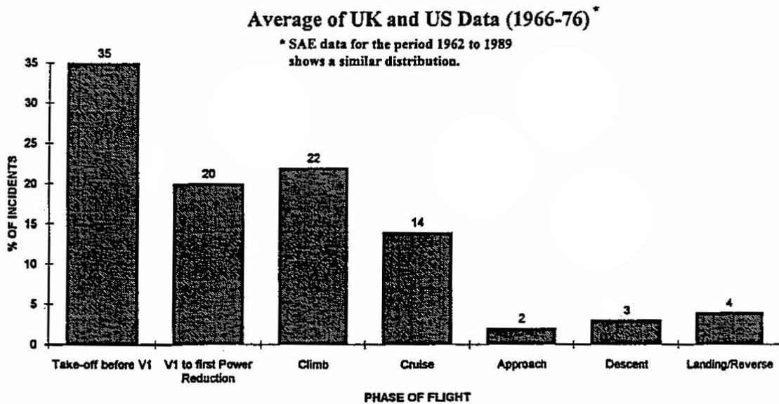
**FIGURE 6 – ALL NON-CONTAINMENTS BY PHASE OF FLIGHT**
